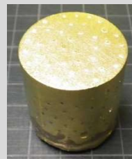
中空鉄球の鑄ぐるみ (Al, Mg, Cu)
