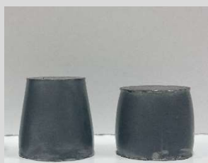
熱間で塑性加工された超硬合金
