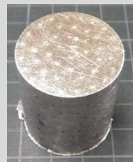
中空鉄球の鑄ぐるみ (Al, Mg, Cu)
