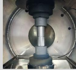
鋼の直接拡散接合
