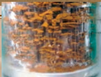
写真は、凍上した土。黄土色の土以外の部分がアイスレンズ
