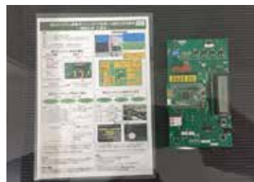
▲組み込みシステム教育用マイコンボード TECL
