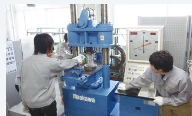
▲圧縮強度試験
