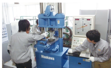
▲圧縮強度試験
