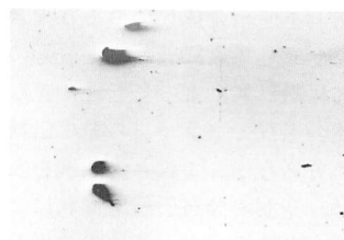
写真 3 - b NC 材 0.1 mm necking 発生部における欠陥とクラック
