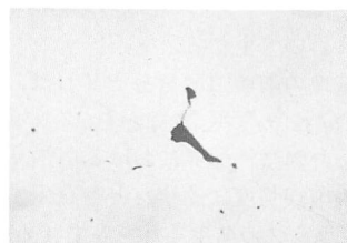
写真 4 - b S 材 0.1 mm necking 発生部における欠陥とクラック
