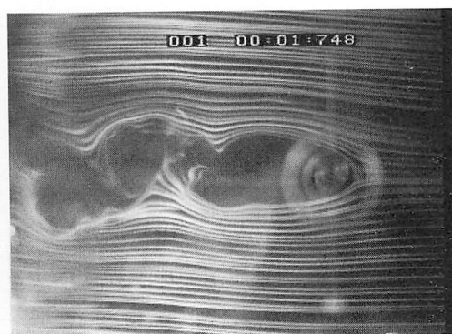
図8 スモークが円柱を通り過ぎるときの連続画像
