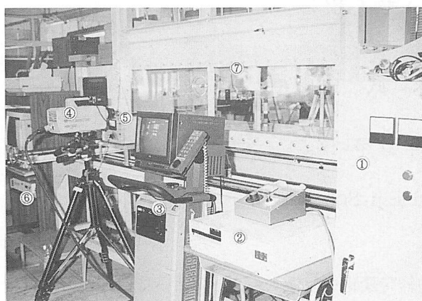
①原動機制御盤 ⑤スモーク・パルス・ジェネレータ ②カラービデオコピー ⑥熱線風速計 ③ハイスピード・ビデオデッキ ⑦照明（白燭光、ストロボライト） ④ハイスピード・ビデオカメラ
