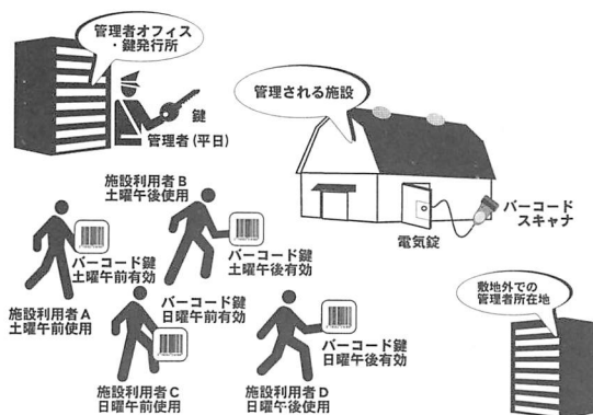
図3 バーコード鍵による施設管理
