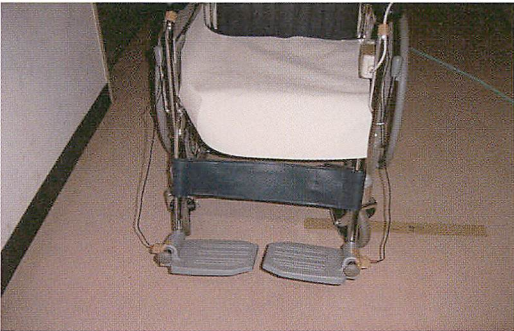
写真-2 耐圧シート
