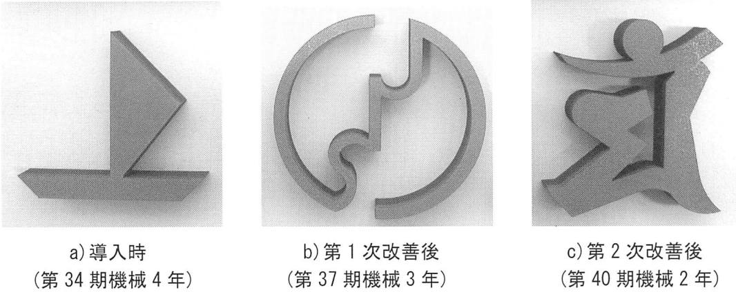
図 3 実習におけるワイヤカット放電加工機的主要加工例
