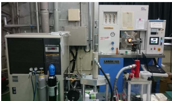
φ10 ~ 20 mm の直径の焼結体試料が作製可能
