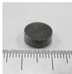
φ10 ~ 20 mm の直径の焼結体試料が作製可能
